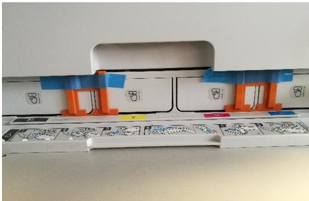
Als nächstes müssen die mitgelieferten Leerkartuschen befüllt werden. Bei der Befüllung ist es wichtig die **richtige** Tintenfarbe in den **entsprechenden** Tank zu füllen! Die jeweils einzufüllende Tintenfarbe ist auf dem Aufkleber auf der Leerkartusche aufgedruckt. Die Farbkürzel haben dabei folgende Bedeutung:
