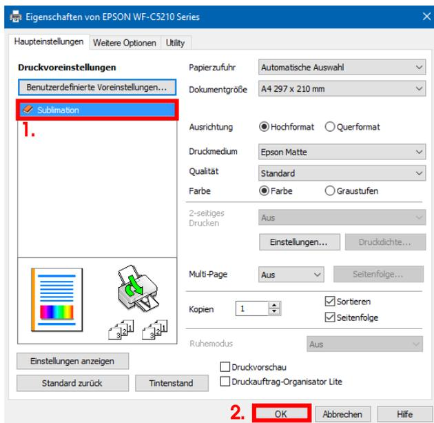
1. Wähle unter „Druckvoreinstellungen“ die Einstellung „Sublimation“ (wird blau unterlegt) durch Mausklick aus.
