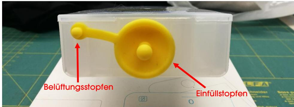
Damit die vorhandene Luft entweichen und sich die Tinte 'beruhigen' kann, die Kartusche nach dem Befüllen hochkant halten (**Belüftungsstopfen immer noch entfernt!**) und ca. **10x leicht** schütteln. Die Kartusche dann für ca. **5min hochkant** stehen lassen.
